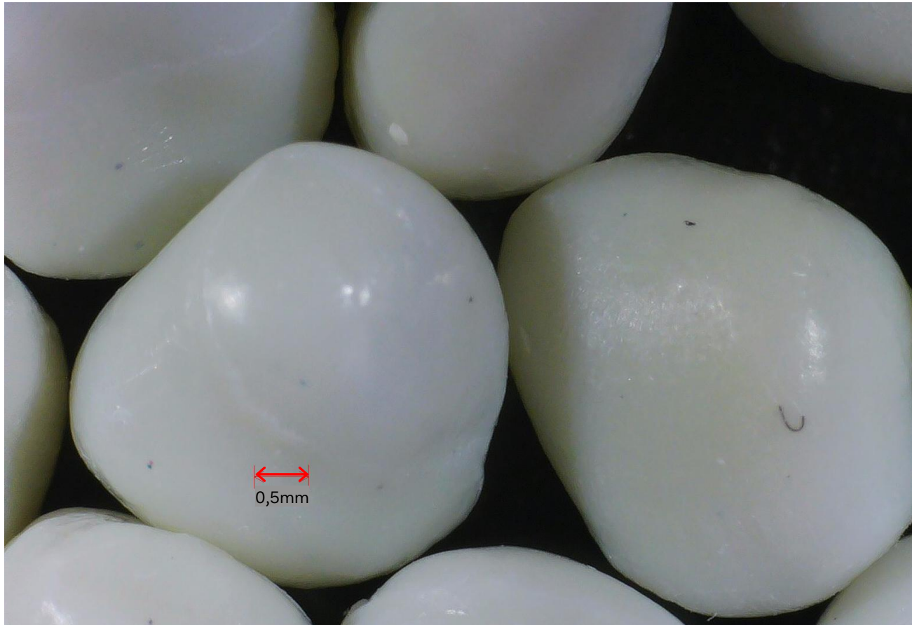
PP-Rezyklat aus gut sortierter, haushaltsnaher Sammlung (98% PCR), 150µm Schmelzefiltration
